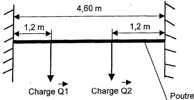
La charge  $Q_1 = Q_2 = 3000$  daN, cette valeur est largement supérieure à la charge utile maximum mais correspondant à celle à mettre en place pour procéder aux essais de résistance du portique. On considère que la poutre est un tube dont le rapport entre le diamètre intérieur et le diamètre extérieur est de 0,8.
