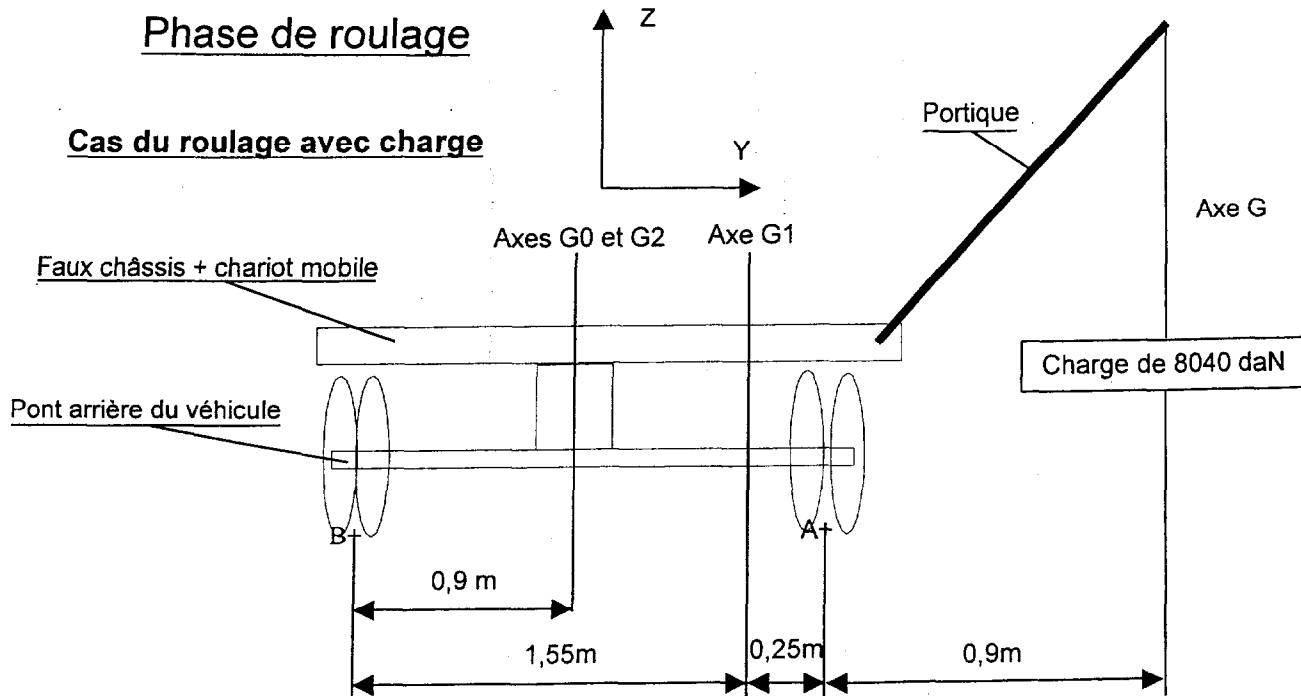
2-5 Un calcul de la charge maximum dans le cas du roulage, pont arrière bloqué et porte palette en appui contre le camion, donne le résultat suivant : Charge maxi = 8040 daN (Voir figure ci-dessus).
